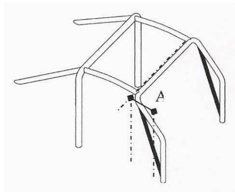
**2 Beispiele unten:** Verstärkung an B-Säule wird empfohlen
